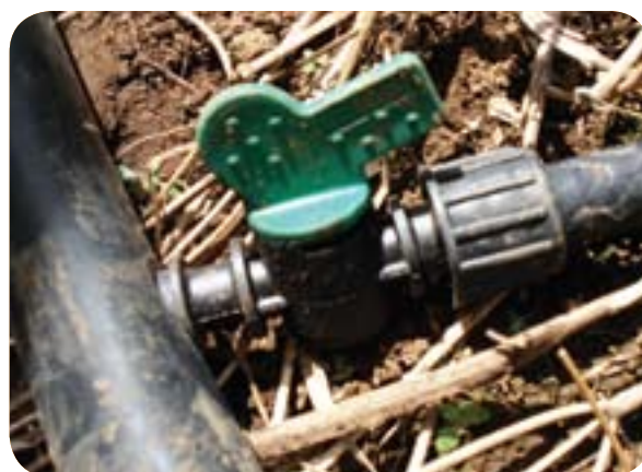
Conexión hacia cinta de goteo.
