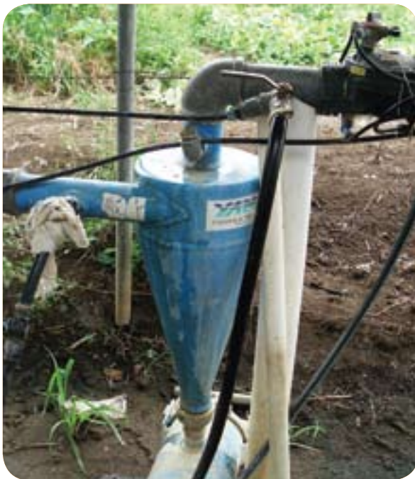
Filtro de arena y limo (hidro-ciclón).
